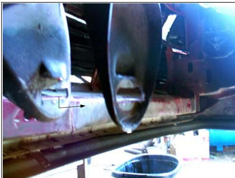
Abbildung 3 – Änderungen an Aufnahme Motoraufhängung vorn, links
