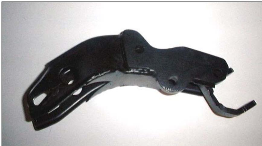
Abbildung 5 – HENNIG Motorsport Umbausatz, hinterer Getriebehalter
