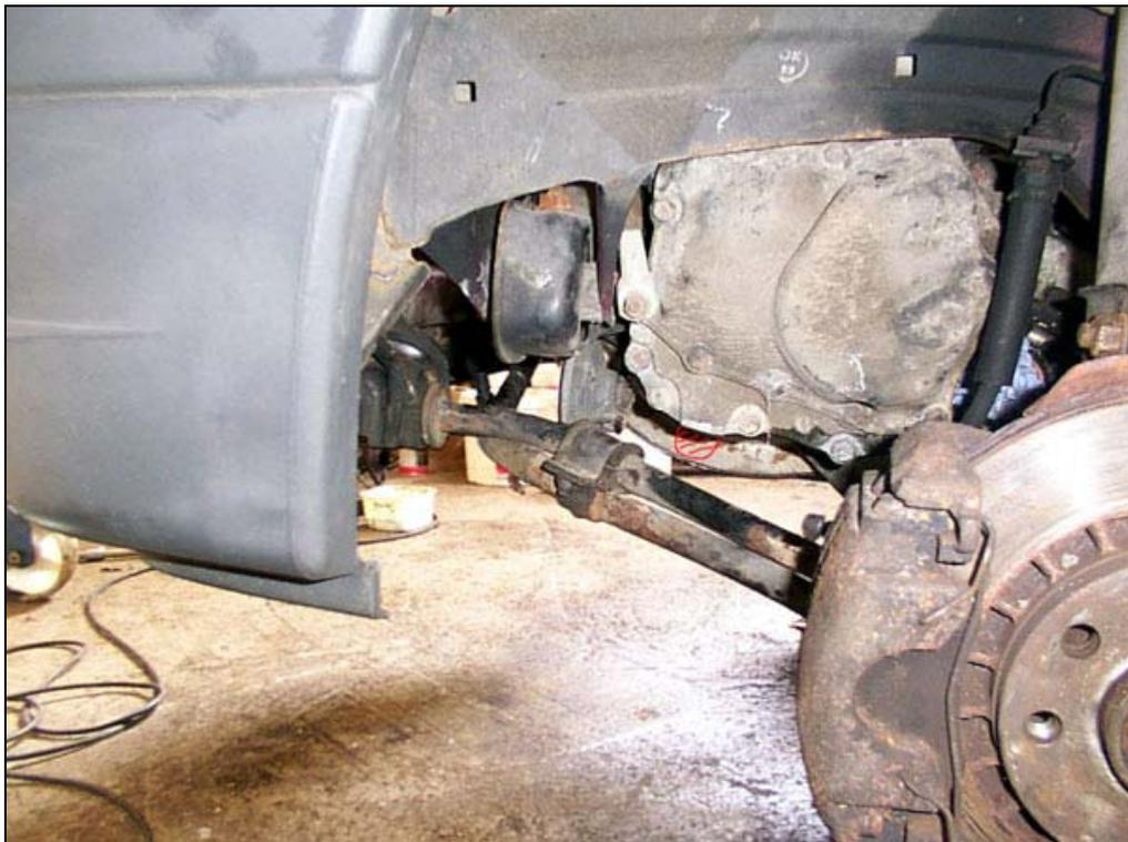
Abbildung 12 – Änderung am Getriebegehäuse
